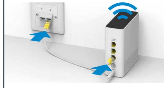
**Hinweis:** Im Verteilerschrank wird der WLAN- und DECT-Empfang stark gedämpft. Zur Verbesserung der WLAN Leistung wird der Anschluss einer WLAN-Box 2 in einem zentralen Zimmer empfohlen. Weitere Infos zur WLAN-Box: [swisscom.ch/wlan-box2](http://swisscom.ch/wlan-box2)
